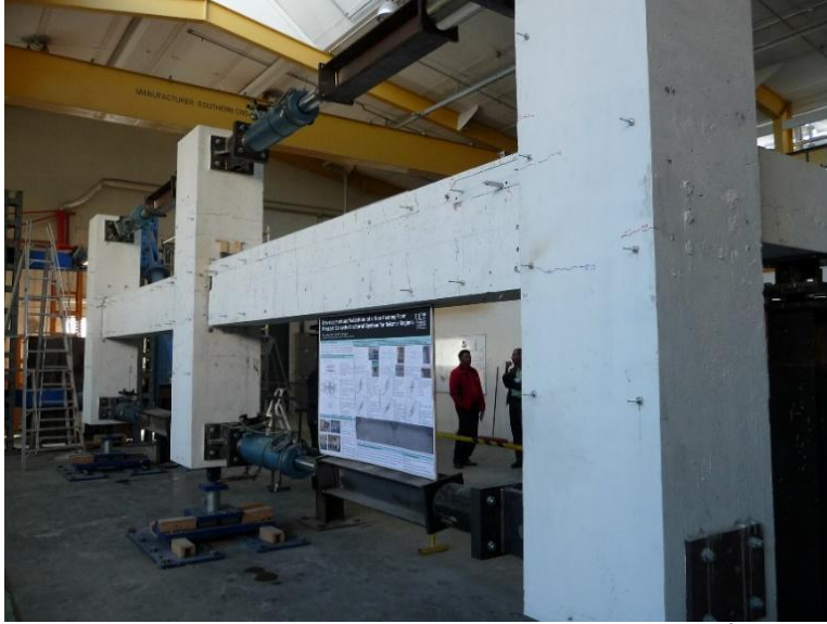
تصویر (۱)۔ ایک تجربہ گاہ میں مضبوط کنکریٹ (reinforced concrete) سے بنے ستونوں (columns) اور بیم (beams) کا تجربہ
